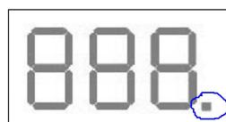
在正常工作界面中、当按
